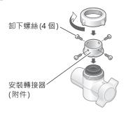
3 先暫時緊固 4 個螺絲, 然後再鬆動螺帽, 留出3~4mm的空隙。
