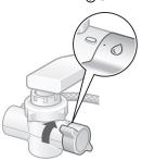
②鬆開螺帽·拆下分水開關·分別取出 過濾網、墊片。
