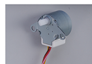
導風板馬達密閉構造
