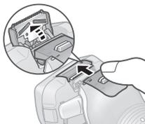
按住頂部旋鈕 (a)，並將修剪器推桿向下滑至修剪器。
