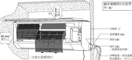
(粘膠型密封劑) 弄轡管線,使其盡量 貼近牆面上,但小心 別弄斷它。 導管連接的隔熱 在檢查是否有氣體洩露後 電源電纜(※) 進行隔熱處理並使用纖維尼 龍膠帶將其固定。 纖維尼龍膠帶(寬)(※) ※纖維尼龍膠帶/ • 包裹之前先進行排水 試驗。 • 進行排水試驗時,取下 將遙控器支架固定到牆面上 空氣濾網,將水倒入熱 交換器。 遙控器支架固定螺絲 ⑥
