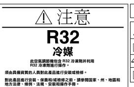
室內機或室外機顯示的符號說明 言符號顯示這個設備使用了一種輕度易燃的沒 東南。如果冷凍劑與外部點火源一起洩漏,則 有可能引燃。 這個符號表示應該仔細閱讀安裝手冊 注意 此符號表示檢修人員應參照"安裝手冊"處理 注意 此設備。 此符號表示操作手冊和/或安裝手冊中包含了  $\mathbf{i}$ 注意
